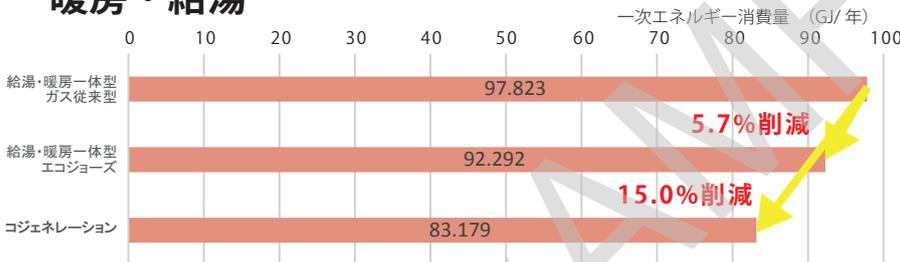
一年を通じて毎日必要な給湯は、住宅の中で最もエネルギー使用量が大きくなります。床暖房を温水で行う場合、従来型（ガス式）と比較して、線熱回収型（エコジョーズ）では5.7%、コージェネレーションでは15.0%削減することが可能です。
